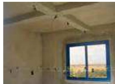
**Fig 12b** : Capteurs installés pour le suivi des émissions du radon.
